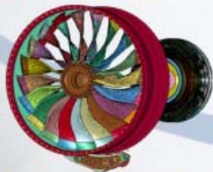
Hybrid Fan Blade Off Analysis
